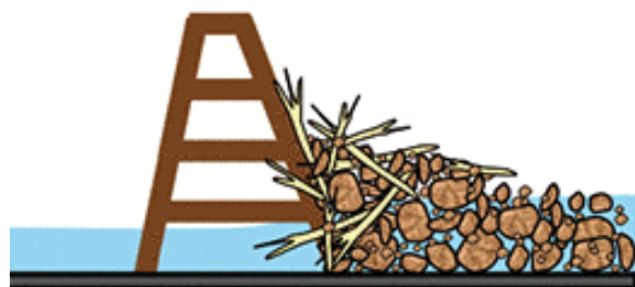
透過部で水と土砂、流木が分離され、捕捉される
