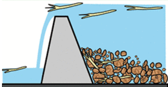
流木は水に浮き、一部が下流に流出
