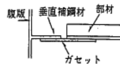
図5 ガセットと垂直補強材
