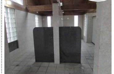
▲トイレ内部中央の壁で死角が発生し個室が見渡せない事例
