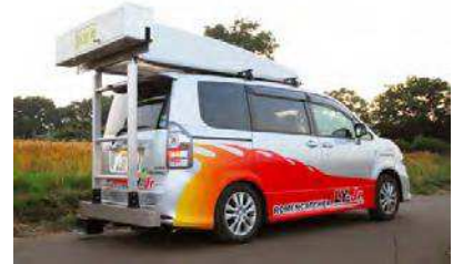
写真. 路面性状測定車両(例)
