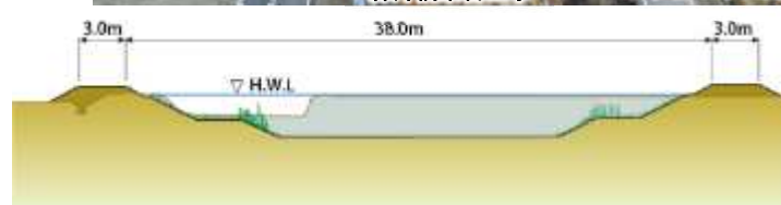
河川整備計画断面図 (下流側)
