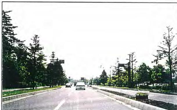
標識を植栽帯に設置し、さらに柱に低彩度の塗装を施すことにより、周囲の街路樹に埋没させ、見通しのよい良好な街路景観を生み出している。
