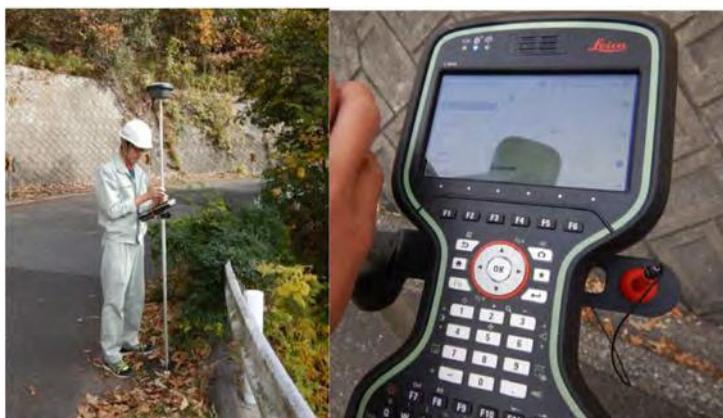
写真 3-1 RTK-GNSS測位器による観測状況 (Leica 社 GS18T)
