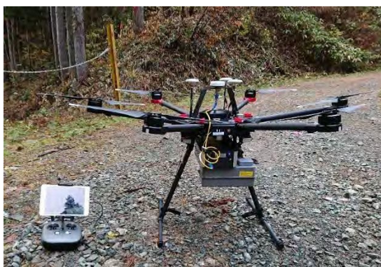
写真 3-2 UAVレーザ測量に用いる機体 (DJI MATRICE600 重量 10kg 最大離陸重量 15.5kg 回転翼 6枚)
