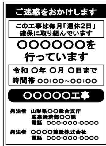
(図) 工事名標示板への明示の例
