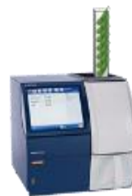
近赤外線分光分析装置（非破壊で効率的に食味成分含有量を測定）
