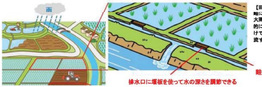
排水口に堰板を使って水の溜さを調節できる
