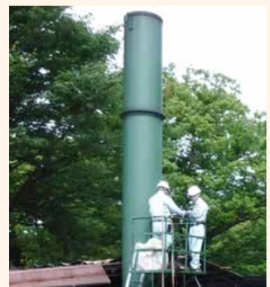
ダイオキシン類排出ガスの採取
