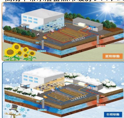
高効率帯水層蓄熱冷暖房システム
