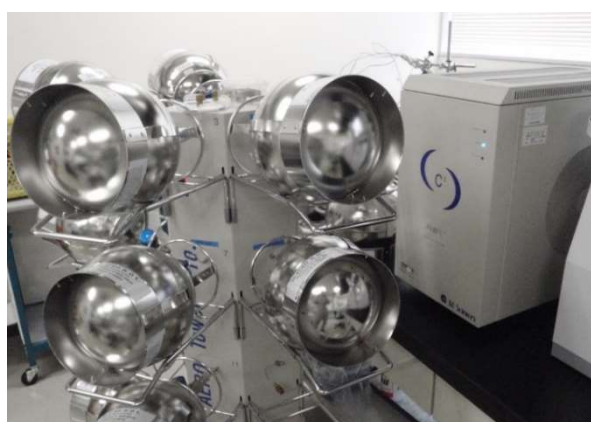
図2 揮発性有機化合物 (VOC類) の分析装置 (キャニスター濃縮導入装置 (左) とガスクロマトグラフ質量分析装置 (右))
