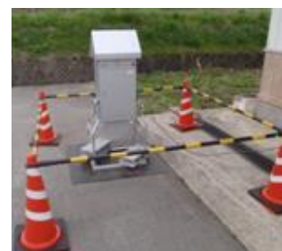
有害大気汚染物質 モニタリング調査で 使用するハイボリューム エアサンプラー
