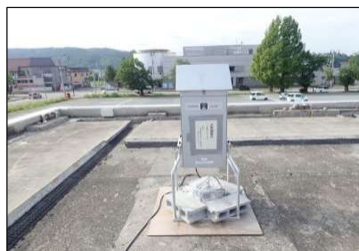
ハイポリウムエアサンブラ（大気の試料を採取する時に使います）
