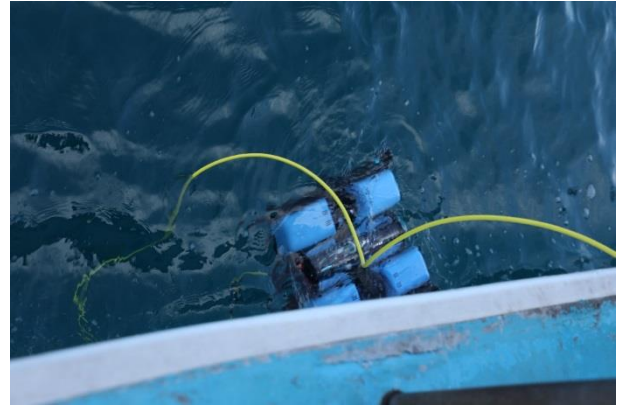
水中ドローン (ROV) 機器本体の潜航状況
